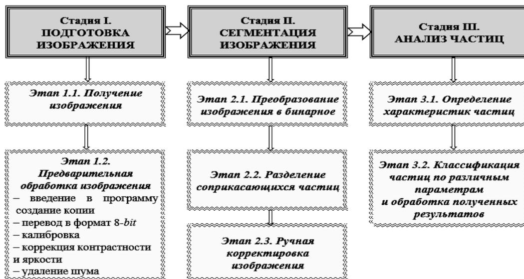
Рисунок 2. Алгоритм определения размеров, количества и формы частиц с использованием программы *ImageJ*
