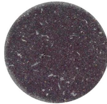
*Рисунок 3. Цифровое изображение фильтрограммы моторного масла*
