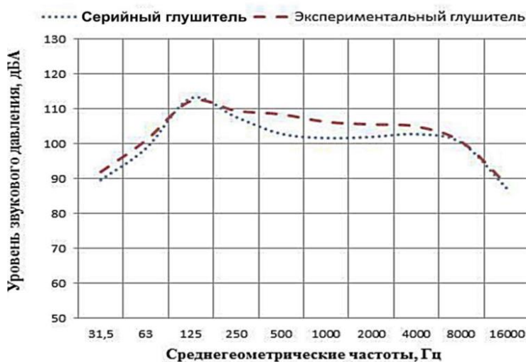
Рисунок 4. Уровень звукового давления на срезе глушителей на режиме эксплуатационной мощности двигателя
