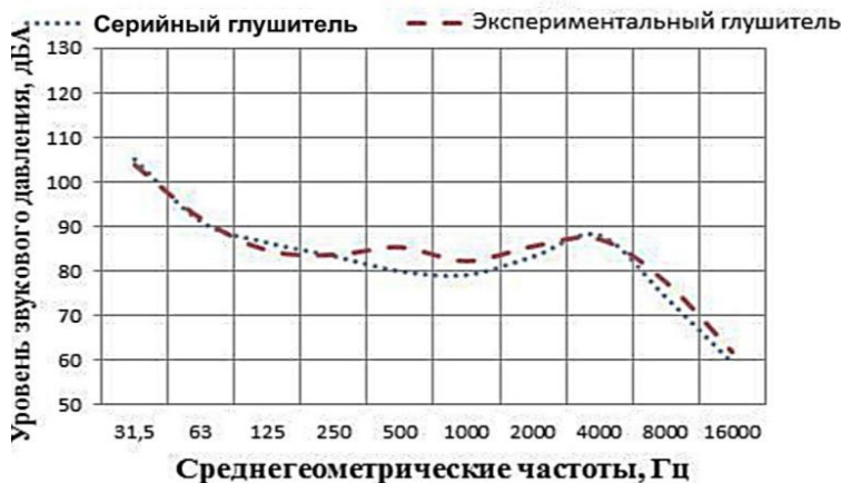
Рисунок 2. Уровень звукового давления на срезе глушителей на режиме холостых оборотов двигателя
