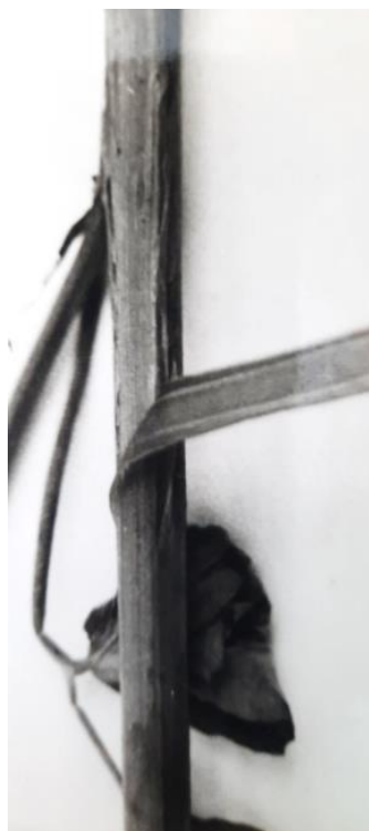
Рисунок 3. Счес покровных тканей со стебля при ударе планкой рабочего органа
