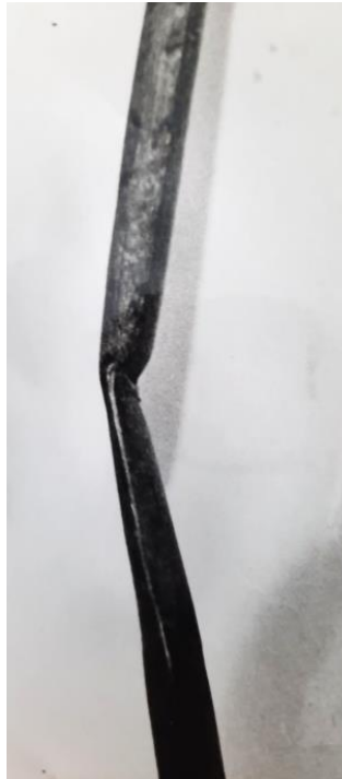
Рисунок 6. Вид перегиба стебля с трещиной
