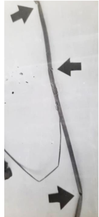
Рисунок 7. Вид стебля с перегибами после плющения ребристыми вальцами
