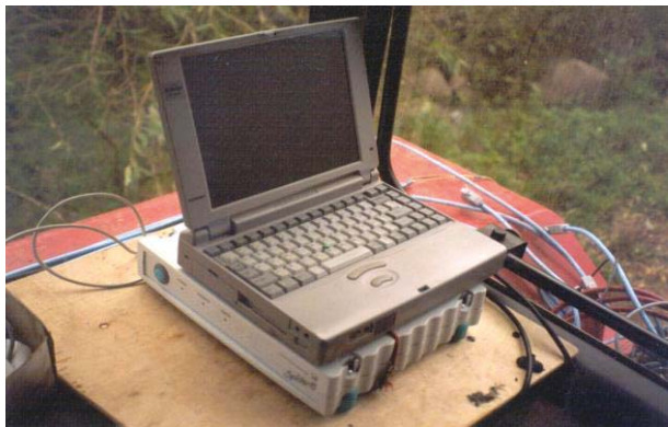
Рисунок 3. Установка мобильного компьютера с программным обеспечением CATMAN-Express и цифрового мобильного измерительного усилителя Spider 8 в кабине гусеничного трактора «БЕЛАРУС» 1802
