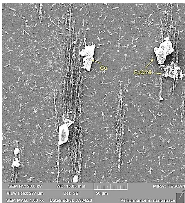
Рисунок 10. Фрагмент феррограммы моторного масла Лукойл Авангард 10W40 с наработкой 150 ч с увеличением: а – 1000×; б – 10000×
