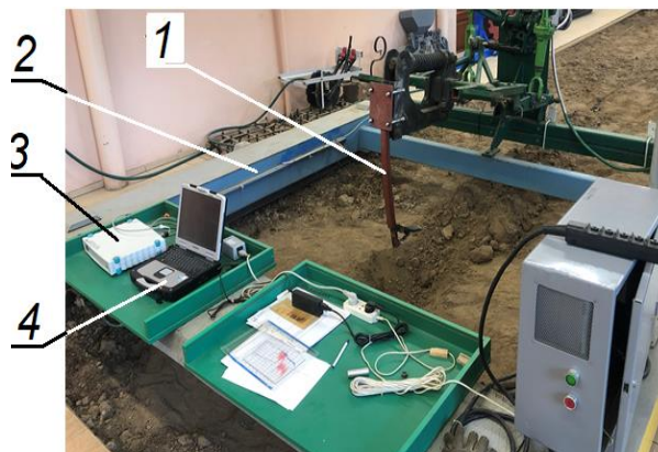
Рисунок 4. Лабораторные исследования рыхлительного органа в почвенном канале БГАТУ: 1 – рыхлительный орган; 2 – тележка; 3 – измерительный комплекс PC Messlektronik «Spider 8»; 4 – ноутбук
