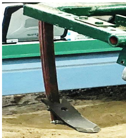
а б Рисунок 5. Рыхлительный орган: а – общий вид; б – в почвенном канале
