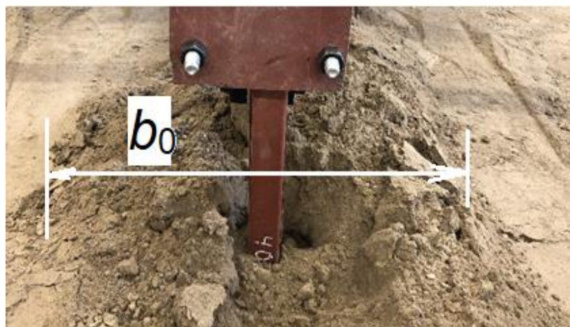
а б Рисунок 5. Рыхлительный орган: а – общий вид; б – в почвенном канале
