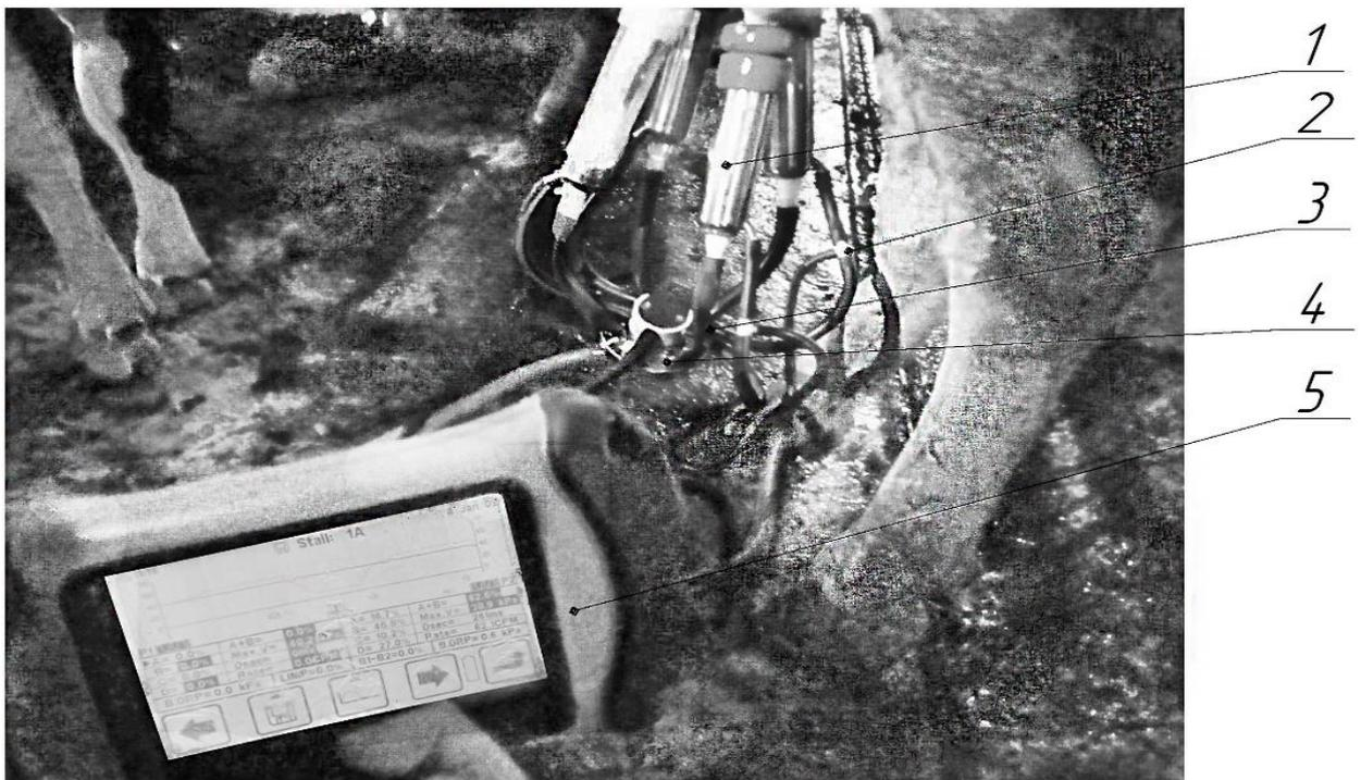
**Рисунок 5. Регистрация параметров доильного аппарата с изменяемым вакуумметрическим давлением в условиях животноводческой фермы СХФ ОАО «УКХ ММЗ» «Светлая Нива»:** 1 – доильный стакан с изменяемым вакуумметрическим давлением; 2 – шланг для измерений пульсационных характеристик доильного аппарата в процессе машинного доения животного; 3 – шланг для измерений величины вакуумметрического давления в подсосковой камере; 4 – коллектор доильного аппарата; 5 – пульсометр VPR-100 Delaval
