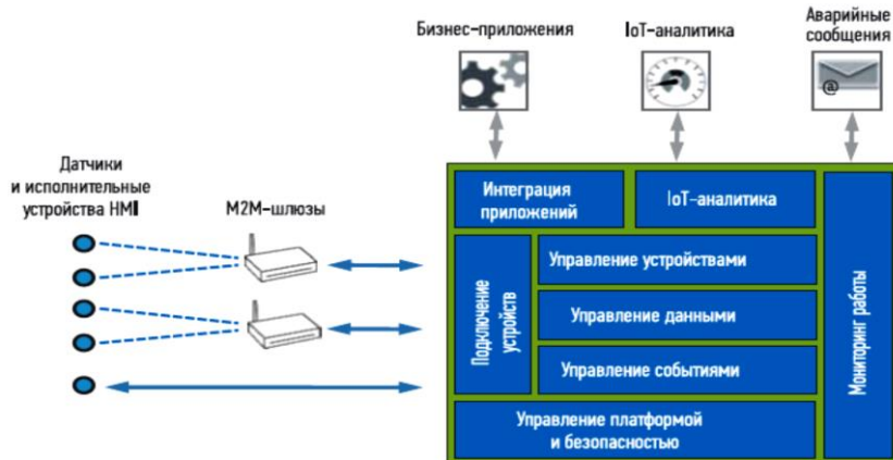
Рисунок 6. Структура системы Cloud-Control
