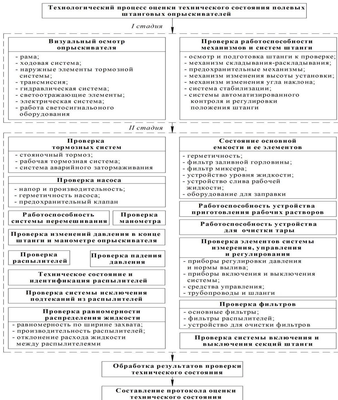
Рисунок 4. Структурная схема процесса оценки технического состояния полевых штанговых опрыскивателей
