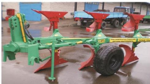
Плуг навесной оборотный ПНО-3-40/50 предназначен для гладкой вспашки старопашотных не засоренных камнями почв с удельным сопротивлением до 0,09 МПа. Плуг агрегируется с тракторами класса 2,0 («Беларус 1221»).
