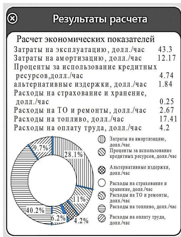
Рисунок 3. Пример расчета затрат на эксплуатацию машинно-тракторного агрегата
