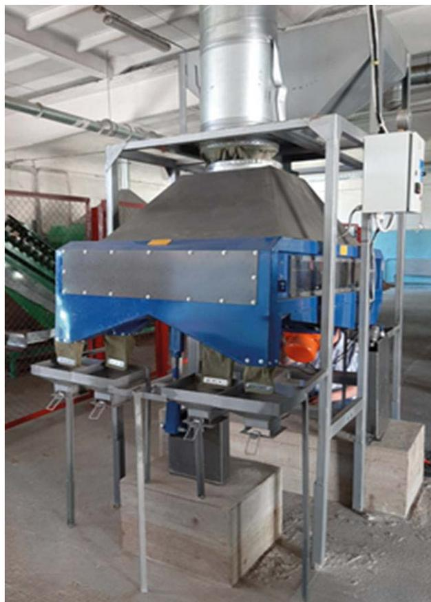
Рисунок 5. Общий вид прямооточного вибропневматического сепаратора
