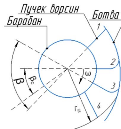
Рисунок 2. Схема взаимодействия ворса щетки с поверхностью листьев ботвы картофеля:
