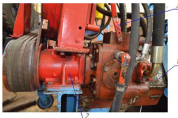
Рисунок 2. Монтаж гидронасоса ГСТ: 1 – диагностируемый насос; 2 – промежуточная опора; 3 – рычаг гидрораспределителя
