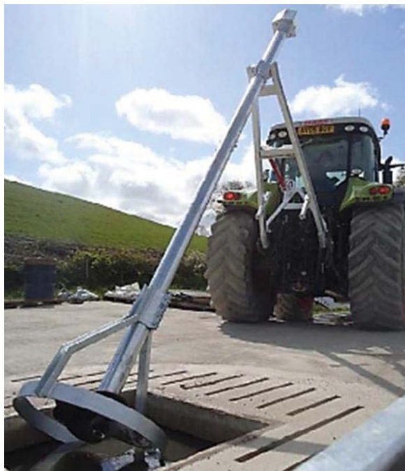
Рисунок 2. Миксер для перемешивания навоза с установленным кожухом
