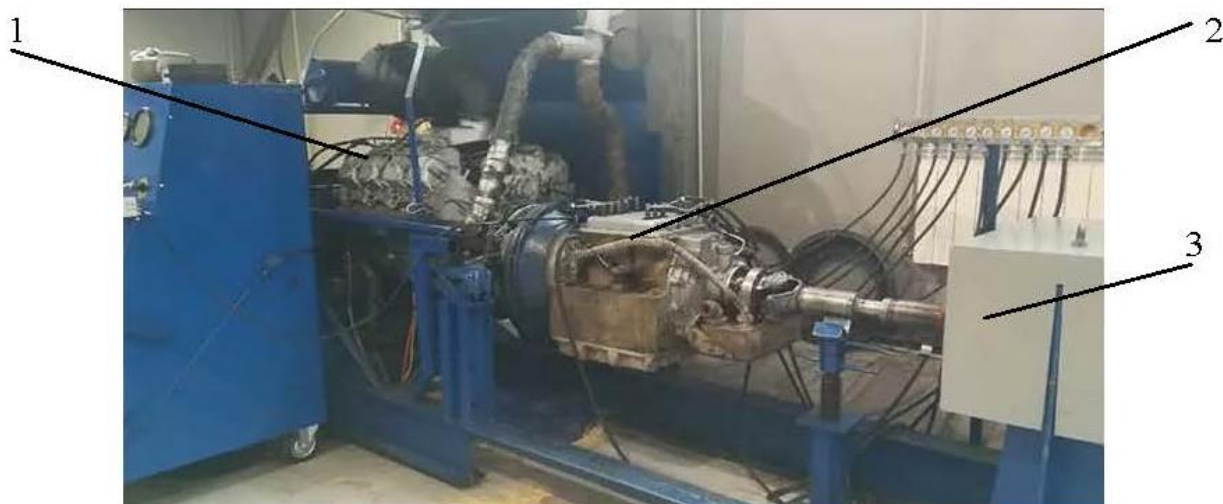
Рисунок 2. Стенд для тестирования и контроля качества ремонта АКПП: 1 – ДВС; 2 – тестируемая АКПП; 3 – нагрузочный блок
