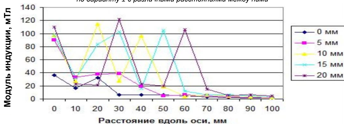
Рисунок 7. Графики распространения магнитной индукции вдоль оси блока из трех магнитов по варианту 2 с различными расстояниями между ними
