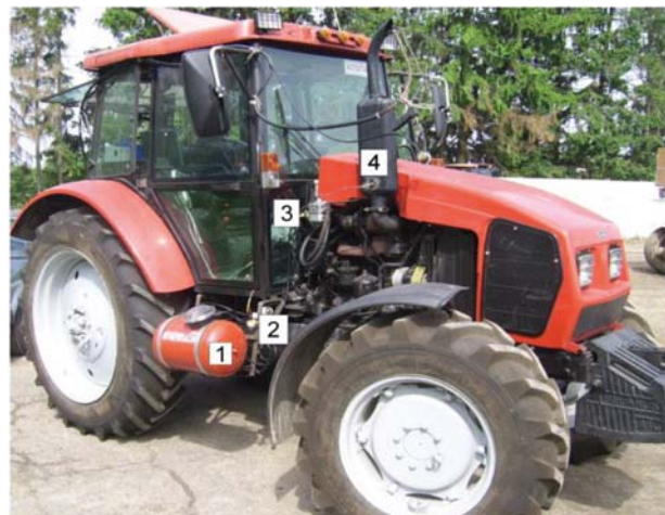
Рисунок 2. Трактор «Беларус-922» с системой подачи газа: 1 – газовый баллон; 2 – выносное запорочное устройство (ВЗУ); 3 – газовый редуктор; 4 – датчик температуры отработанных газов
