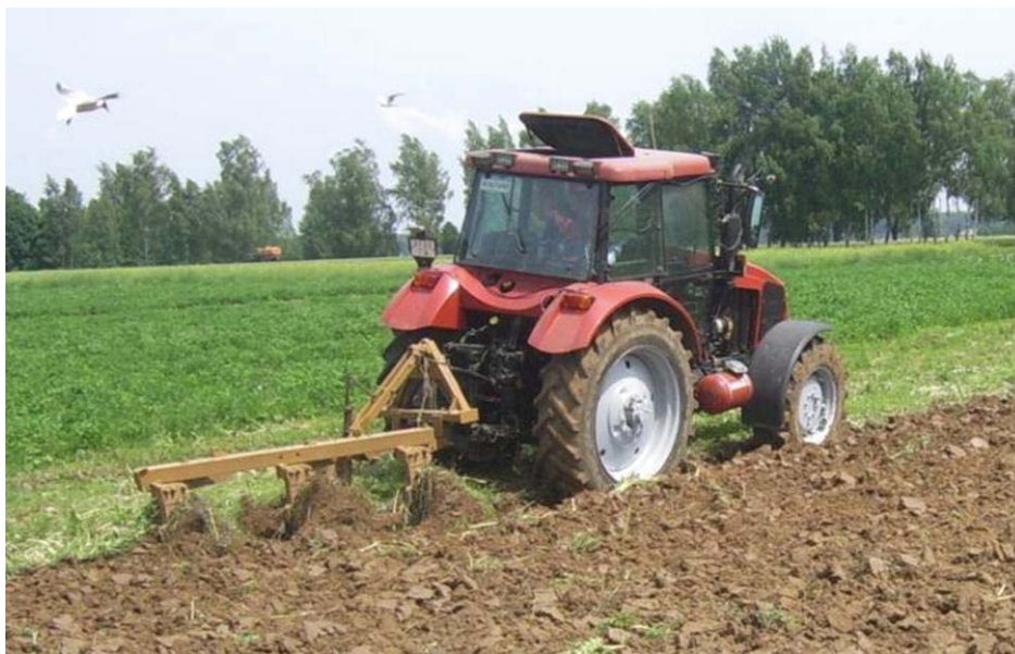
Рисунок 3. Работа МТА «Беларус-922» + ПЛН-3-35 при работе на СДГТ
