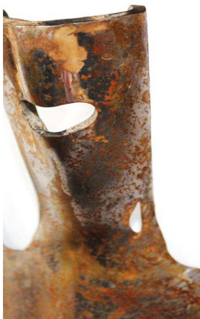
Рисунок 1. Причины потери работоспособного состояния стрелчатых лап: а – износ носка и крыльев по ширине (на примере новой и изношенной лап); б – износ крепежной части
