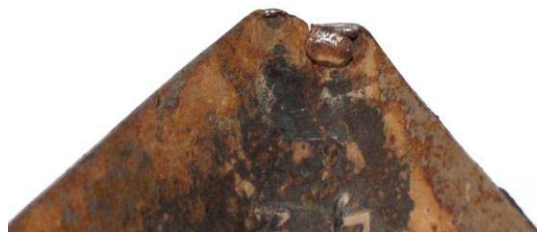
Рисунок 2. Носок культиваторной лапы после изгиба и обламывания
