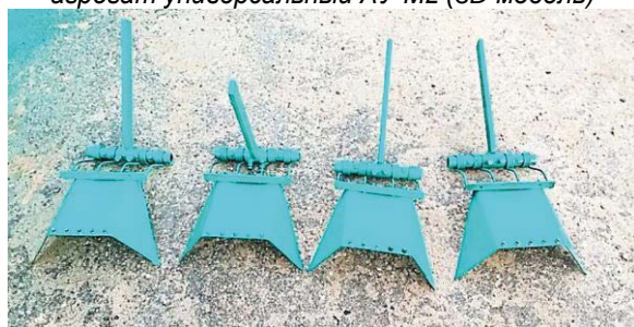
Рис. 4. Устройство для формирования профиля узкопрофильных гряд для установки на агрегат универсальный АУ-М2 (фото комплекта)
