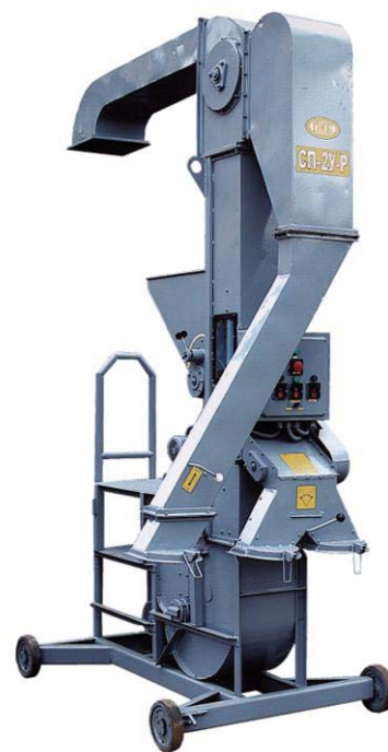
Рис. 1. Конструктивно-технологическая схема (а) и общий вид (б) опытного образца пневмосепаратора СП-2У-Р для очистки от примесей семян трав и зерна: 1 – ротационный поперечно-поточный пылеуловитель; 1 – вентилятор; 2 – пневмосепарирующий канал; 3 – ротационный пылеуловитель; 4 – пылесадительная камера; 5 – тканевый фильтр; 6 – приемное устройство; 7 – дроссельное устройство; 8 – задвижка; 9 – смотровое окно; 10 – воздуховод; 11 – материалопроводы; 12 – сменная сетка; 13 – мешки
