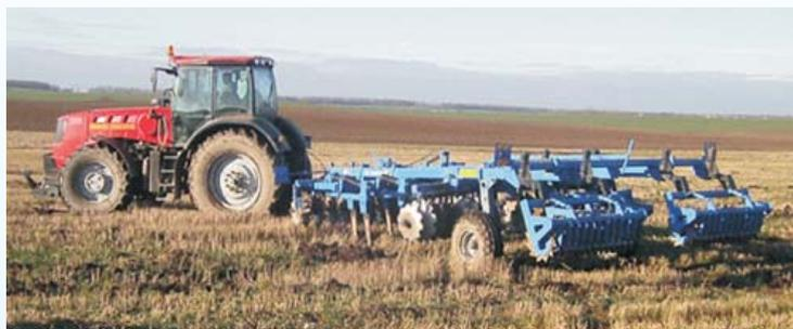
Предназначен для безотвальной обработки тяжелых почв на глубину до 35 см, лущения жнивья, обработку почвы на зябь после уборки кукурузы, свеклы и картофеля, мульчирования, выравнивания и прикатывания поверхности поля, а также для подготовки окультуренных почв за 2 прохода под посев озимых зерновых, пожнивных и поукосных культур.
