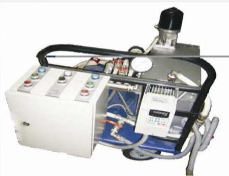
Применение установки позволит повысить качество и продлить срок службы моторных и гидравлических масел. Она может использоваться на предприятиях по ремонту и техническому сервису машинно-тракторного парка, а также непосредственно в хозяйствах. Данную установку можно использовать также для профилактической очистки свежих масел, в которых количество загрязнений выше допустимых пределов.
