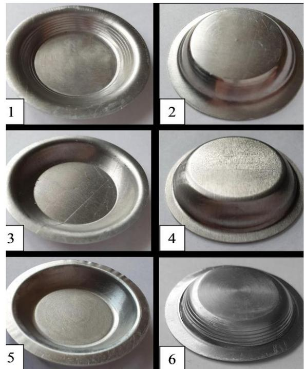
Рис. 1. Отштампованные образцы детали, верхней и нижней прокладок
