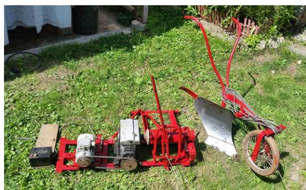
Рис. 4. Схема (а) и общий вид (б) лабораторной установки: 1 – электротяга; 2 – трос; 3 – камера; 4 – плуг; 5 – индикаторный слой
