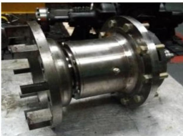
Рис. 1. Макет образца устройства сдвигания ведущих колес с механизмом блокировки
