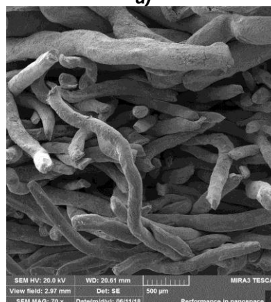
Рис. 4. Микроструктура хрупкого излома двух- слойного ФЭ из МКО: а) в увеличении \times 50 ; б) в увеличении \times 70
