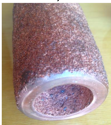
Рис. 3. Двухслойные ФЭ из МКО фракций: а) (-0,4...+0,315) и (-0,315...+0,2) мм; б) (-0,4...+0,315) и (-0,315...+0,2) мм
