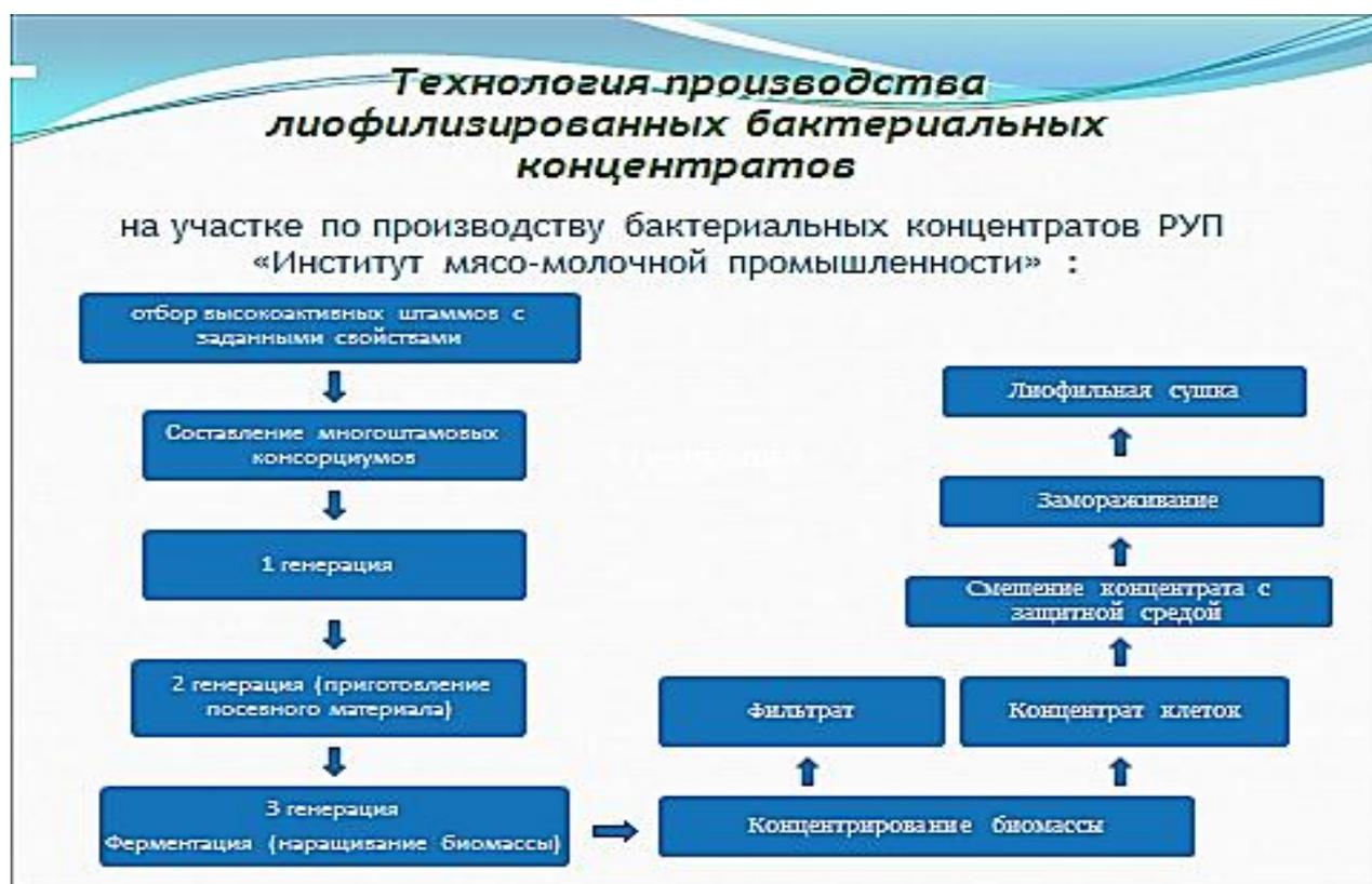
Рис. 2. Технологическая схема производства
