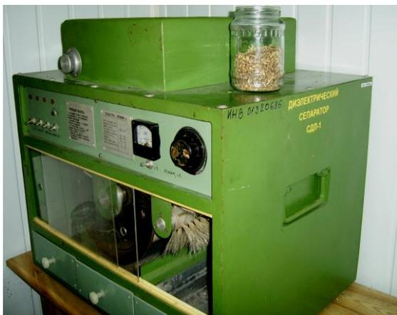
Рис. 1. Диэлектрическое сепарирующее устройство
