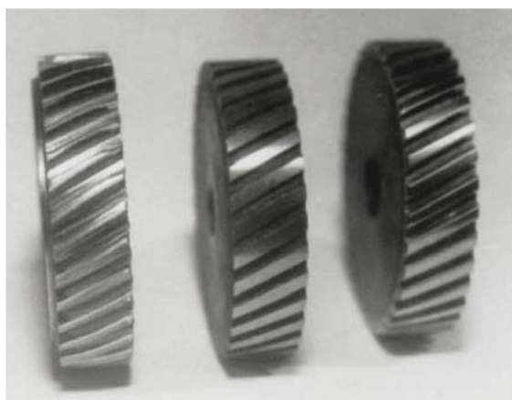
а б в Рис. 5. Заготовка зубчатого колеса: а – после шлифования; б – после термической обработки и шлифования; в – после МАО
