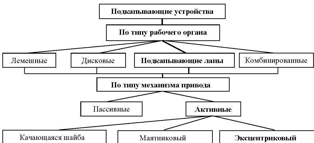
Рис. 2. Классификация подкапывающих устройств
