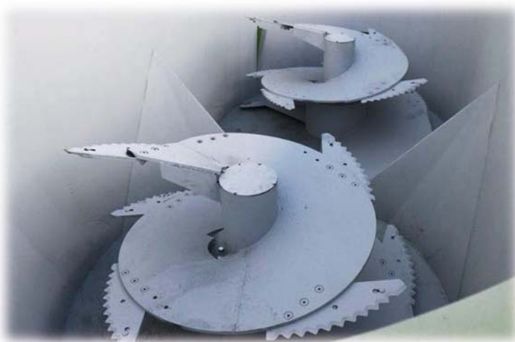
Рис. 2. Расположение рабочих органов смесителя-кормораздатчика: а – с горизонтальным расположением шнеков (ИСРК-12); б – с вертикальным расположением шнека (СРК-12В)
