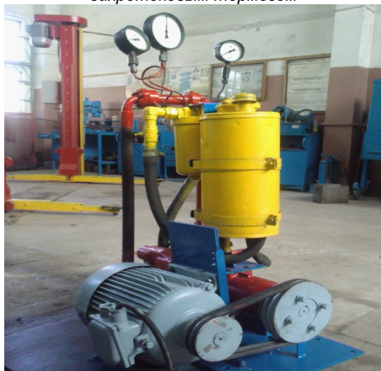
Рис. 2. Экспериментальный образец обкаточно-тормозного устройства мощностью до 120 кВт
