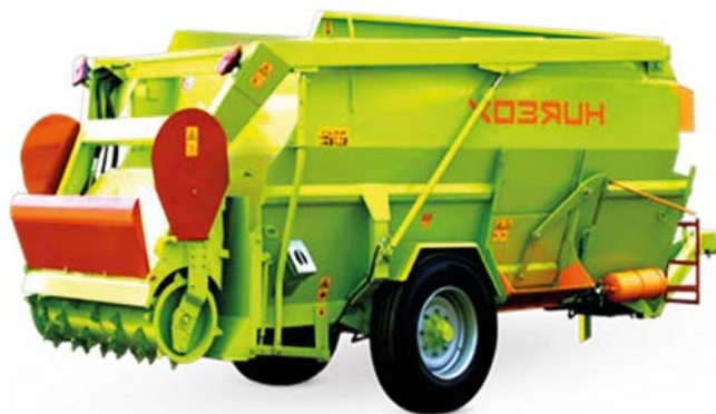
Рис.1. Измельчитель-смеситель-раздатчик кормов с наличием загрузочной фрезы ИСРК-12Ф
