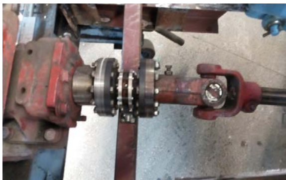
Рис. 3. Датчик крутящего момента М40
