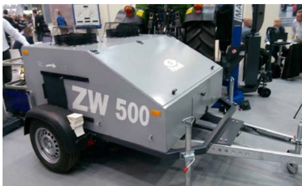
Рис. 1. Передвижной тормозной стенд ZW 500 с вихрековым тормозом
