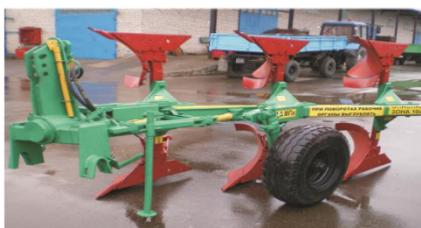
Плуг навесной оборотный ПНО-3-40/50 предназначен для гладкой вспашки старопахотных не засоренных камнями почв с удельным сопротивлением до 0,09 МПа. Плуг агрегируется с тракторами класса 2,0 («Беларус 1221»).
