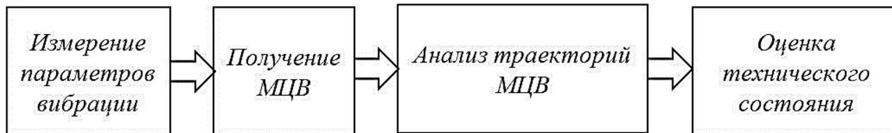
Рис. 1. Общий вид вибродиагностики объекта по МЦВ
