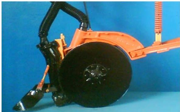
Рисунок 1. Комбинированный двухдисковый сошник
