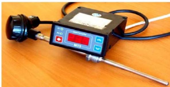
*Измерители-регуляторы МТ2 являются универсальными цифровыми программируемыми микропроцессорными устройствами. Они могут быть использованы при создании систем автоматического контроля и регулирования различных параметров технологических процессов в промышленности и сельском хозяйстве.*
