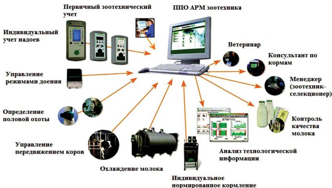
Рисунок 1. Структура системы управления стадом КРС
