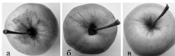
Рисунок 6. Поверхность яблок в области углубления у плодоножки после очистки в разных условиях: обычная мойка с хаотическим перемещением, когда плодоножка попеременно обращается то вниз, то вверх (а); УЗ очистка в неподвижном состоянии, когда плодоножка постоянно обращена вверх (б) или вниз (в)
