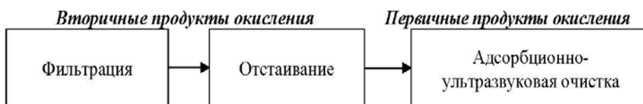
Рисунок 2. Схема очистки нерафинированного масла от первичных и вторичных продуктов окисления
