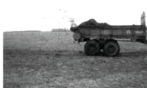
Рисунок 8. Определение неравномерности внесения твердых органических удобрений базовым разбрасывателем
