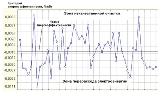
Рисунок 6. Критерий энергоэффективности комбинированных систем водоочистки
