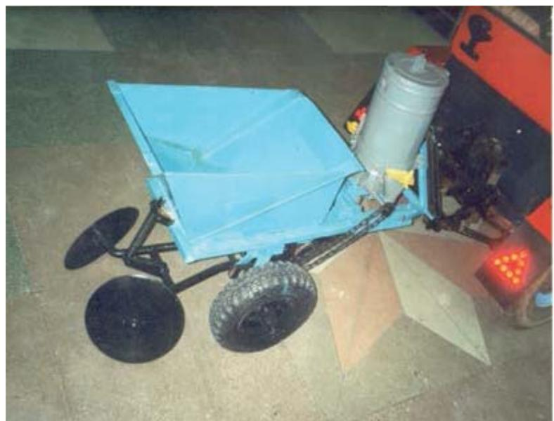
Рисунок 1. Роторная картофелесажалка
