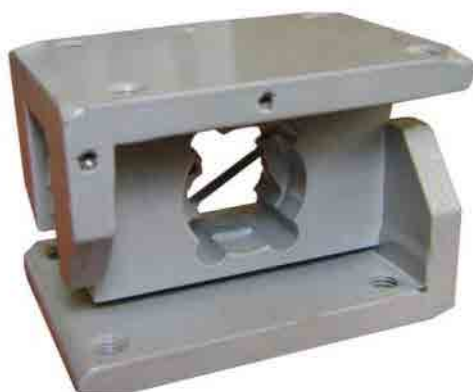
Рисунок 2. Упругий элемент динамометра на малые усилия
