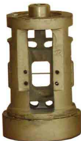
Рисунок 1. Упругий элемент динамометра стержневого типа
