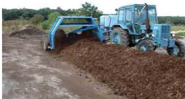
Рисунок 1. Прицепной роторно-лопастной аэратор навозно-компостных смесей в работе
