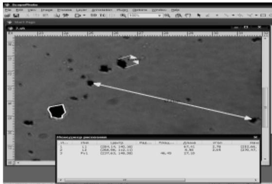
Рисунок 3. Микроизображение агрегатов углеродных наночастиц с нанесенными измерительными линиями и измерительным контуром
