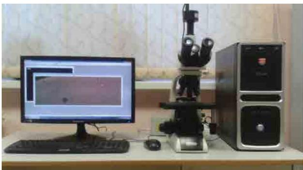
Рисунок 2. Компьютерный микроскоп на базе микроскопа Микмед-6
