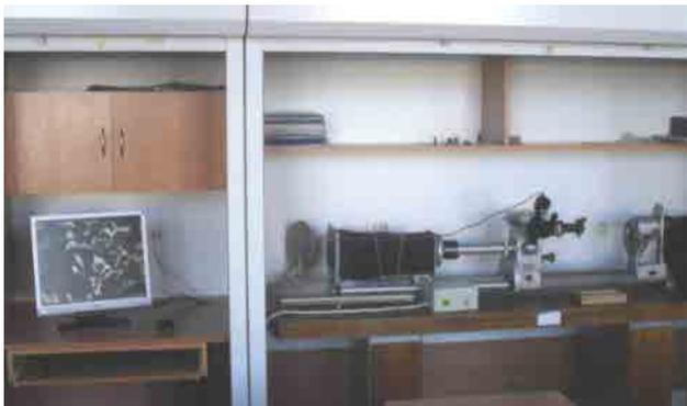
Рисунок 1. Компьютерный микроскоп на базе микроскопа МИМ-8
