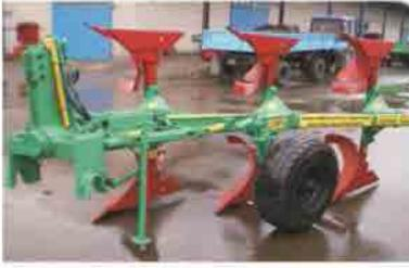
Плуг навесной оборотный ПНО-3-40/50 предназначен для гладкой вспашки старопахотных не засоренных камнями почв с удельным сопротивлением до 0,09 МПа. Плуг агрегатируется с тракторами класса 2,0 («Беларус 1221»).
