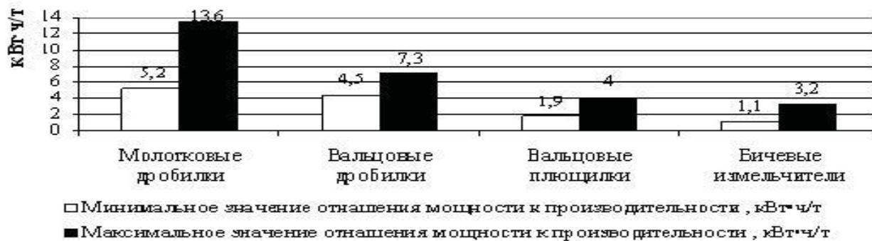
Рисунок 3. Сравнение максимальных и минимальных значений отношения мощности к производительности
