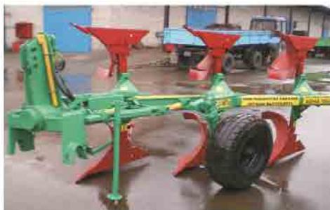
Плуг навесной оборотный ПНО-3-40/50 предназначен для гладкой вспашки старопахотных не засоренных камнями почв с удельным сопротивлением до 0,09 МПа. Плуг агрегатируется с тракторами класса 2,0 («Беларус 1221»).
