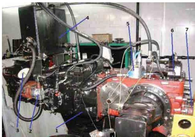
Рис.3. Двухпоточная передача заднего вала отбора мощности, разработанная для трактора «БЕЛАРУС 1221» на ПО «МТЗ»: 1 – трансмиссия трактора «БЕЛАРУС 1221»; 2 – насос НШ 32М-3; 3 – манометр; 4 – бак с рабочей жидкостью; 5 – шестеренный расходомер с датчиками расхода, давления и температуры; 6 – гидромотор фирмы Linde модели HMF36-02; 7 – хвостовик заднего ВОМ
