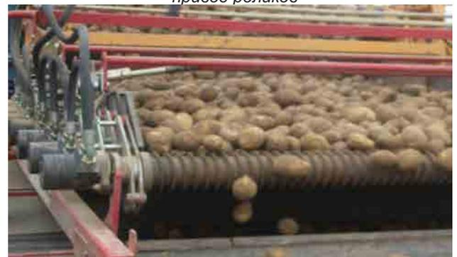
Рисунок 3. Роликовая поверхность ПБВ-40
