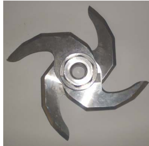
Рисунок 4. Ножевая головка куттера с разработанными ножами
