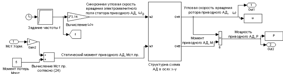
Рисунок 6. Имитационная модель подсистемы «Приводной АД», соответствующая системе уравнений (9) и уравнению (24)
