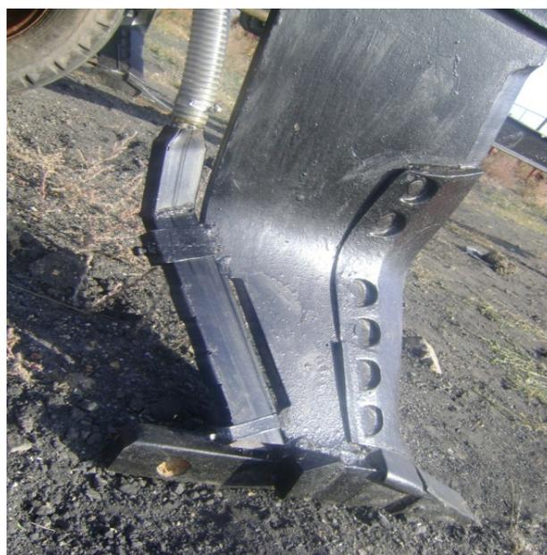
Рисунок 1. Наклонный рабочий орган
