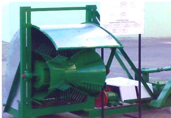
*Рисунок 3. Опытный образец машины для сбора клещевины очесом*
