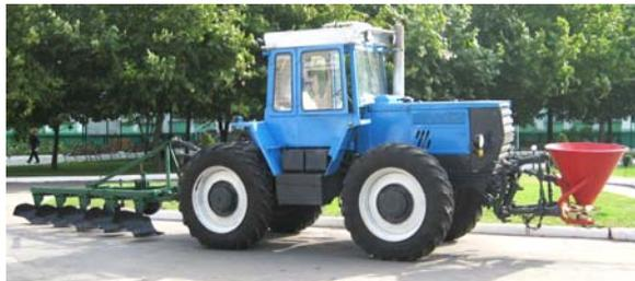
Рисунок 2. Комбинированный МТА на основе трактора серии ХТЗ-160
