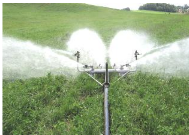
Рисунок 4. Общий вид оборудования поливочного ОП-600 в работе
