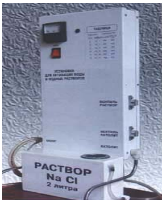
Рис. 1. Общий вид установки электрохимической активации слабых растворов соли
