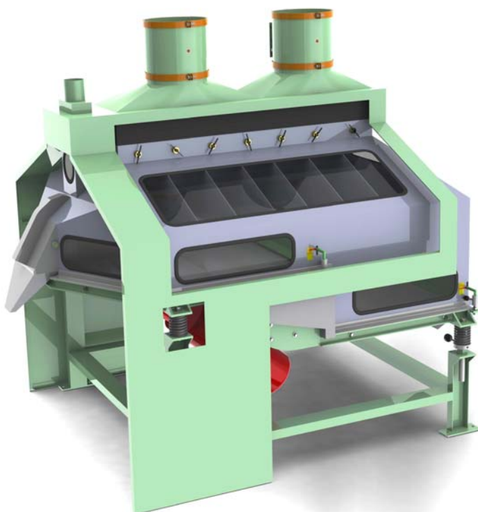
Рисунок 5. Общий вид опытного промышленного вибропневмосепаратора для очистки семян
