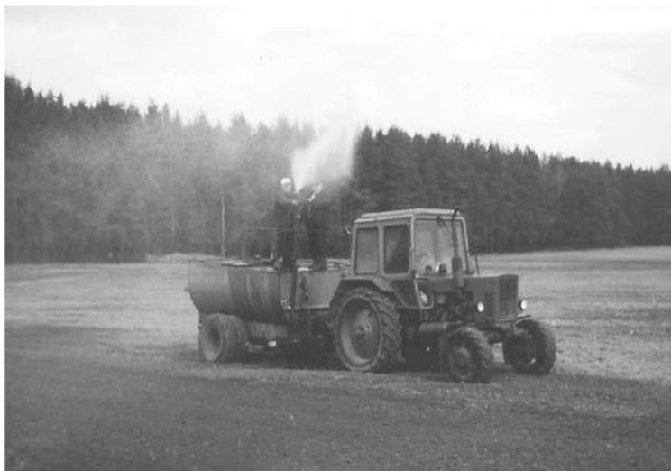
Рисунок 1. Экспериментальная гидросеялка на полях агротехнологического полигона БГАТУ (2005г.). Закладка опыта-пробы
