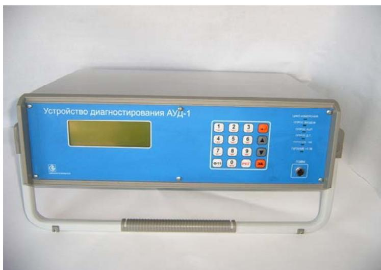
*Рисунок 1. Внешний вид прибора для диагностирования асинхронных двигателей*
