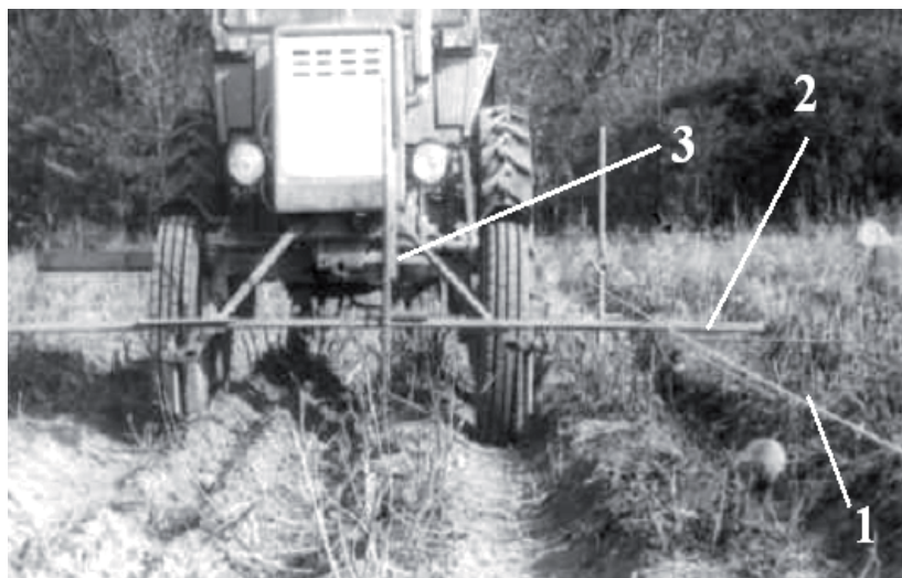
Рисунок 2. Приспособление для измерения ординат z_{ГТ} и z_K
