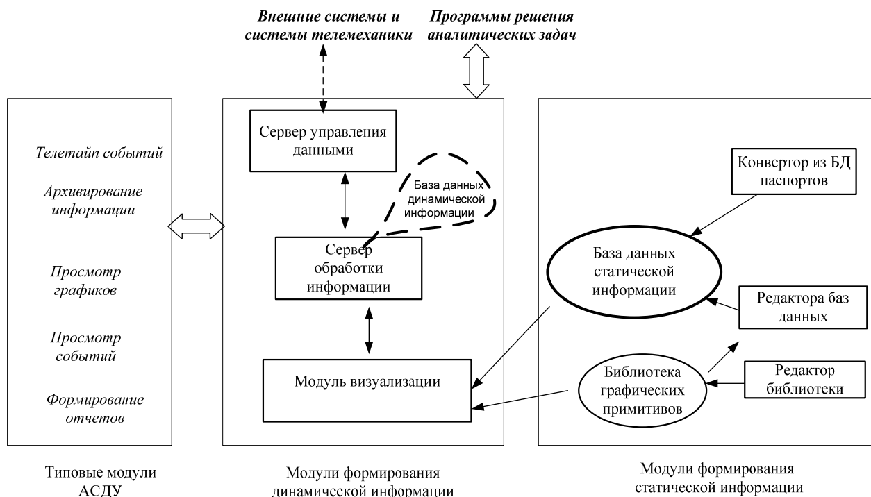
Рисунок 2. Архитектура программного обеспечения АСДУ
