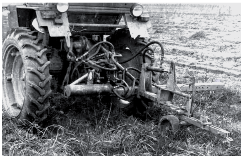
Рисунок 1. Установка для исследования взаимодействия копирующего катка с рельефом: а – принципиальная схема; б – общий вид.
