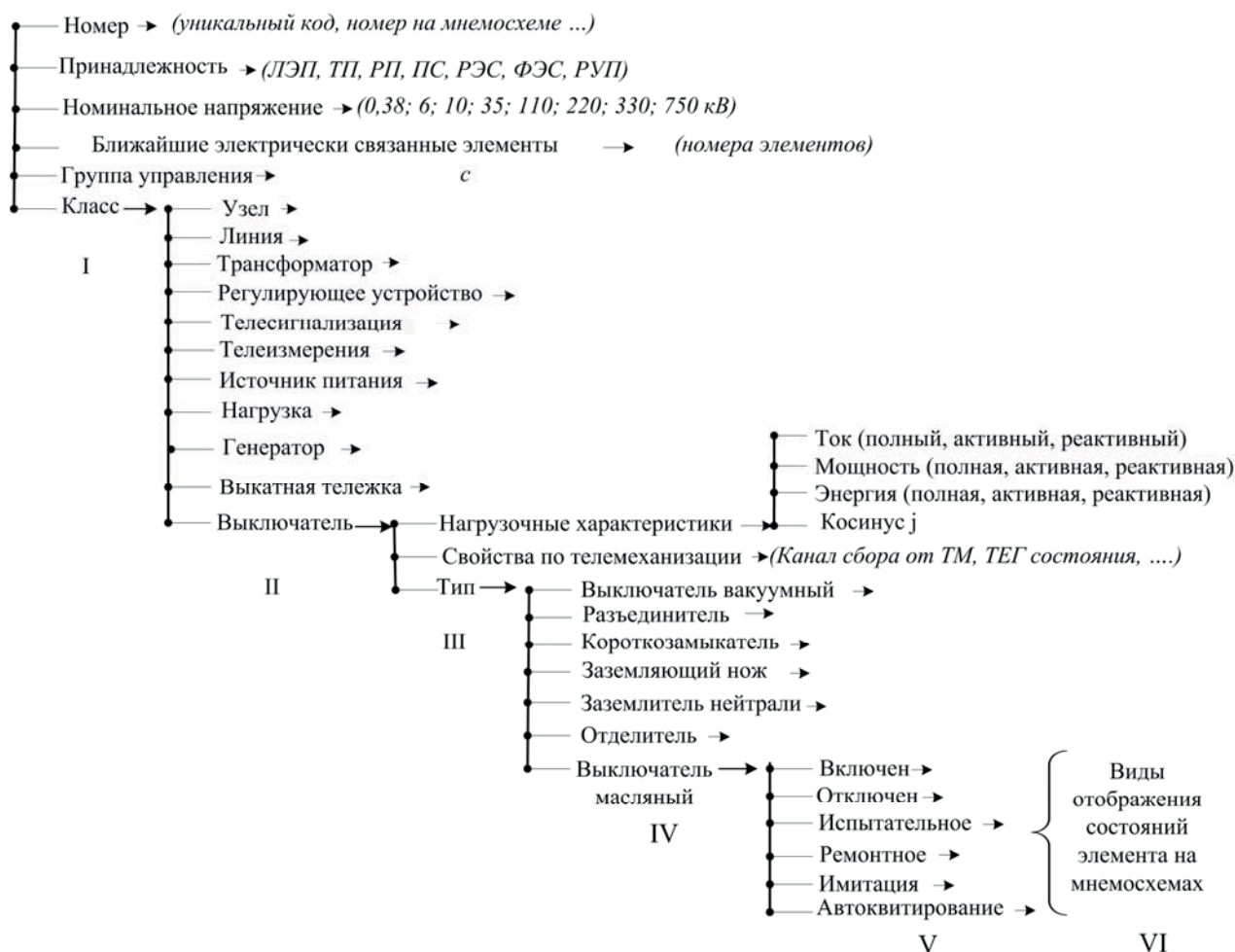
Рисунок 1. Структура свойств элементов электрической сети
