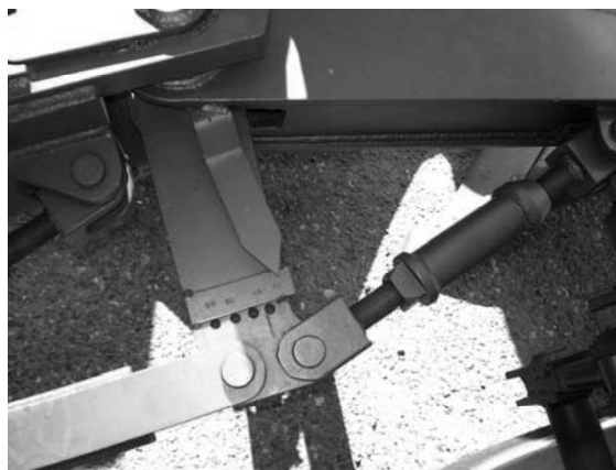
Рисунок 2. Механизм поворота рамы (а) и изменения ширины захвата плуга (б; в)
