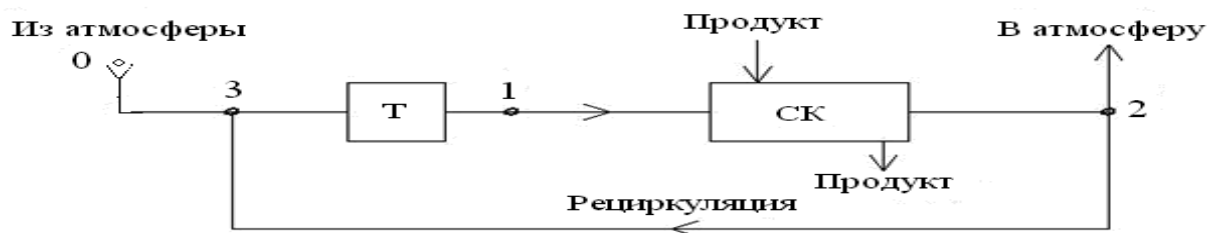
Рисунок 1. Принципиальная схема сушильной установки с рециркуляцией сушильного агента
