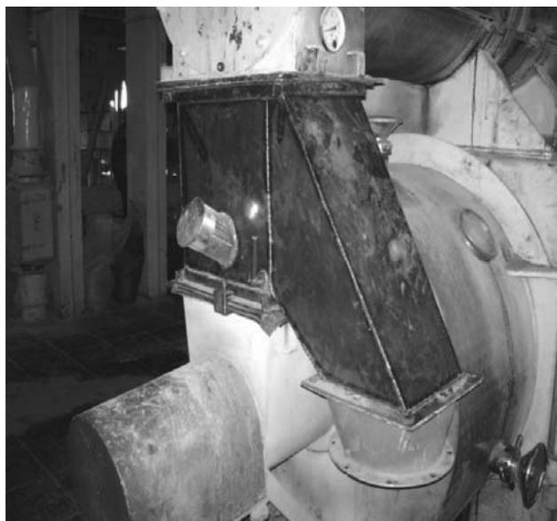
Рисунок 1. Перекидной клапан
