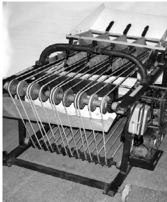
Рисунок 5. Лабораторная машина для сортирования корнеплодов
