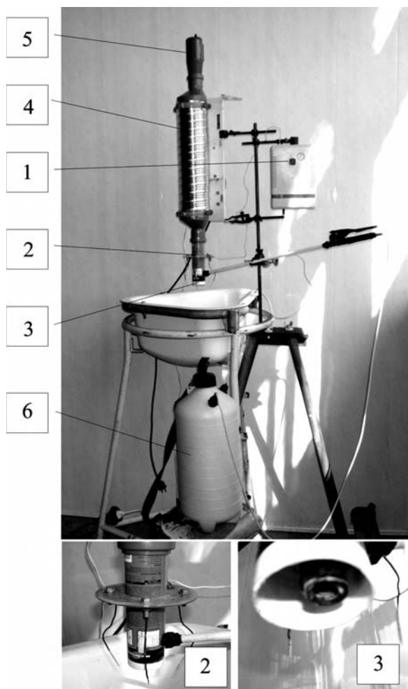
Рисунок 1. Лабораторная установка для исследования процесса электронно-ионного нанесения жидких реагентов на плющенное зерно: 1 – высоковольтный импульсный генератор; 2 – воздушный канал с коронной заострённых электродов; 3 – размещение распылителя в воздушном канале; 4 – корпус озонатора-ионатора; 5 – проточный вентилятор; 6 – герметичная ёмкость с жидким реагентом.
