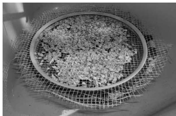
Рисунок 3. Плющенное зерно овса на трёхъярусном сетчатом основании.
