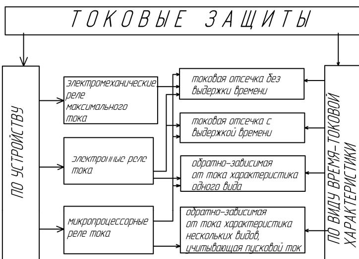
Рисунок 2. Виды токовых защит по устройству и виду времени – токовой характеристики.
