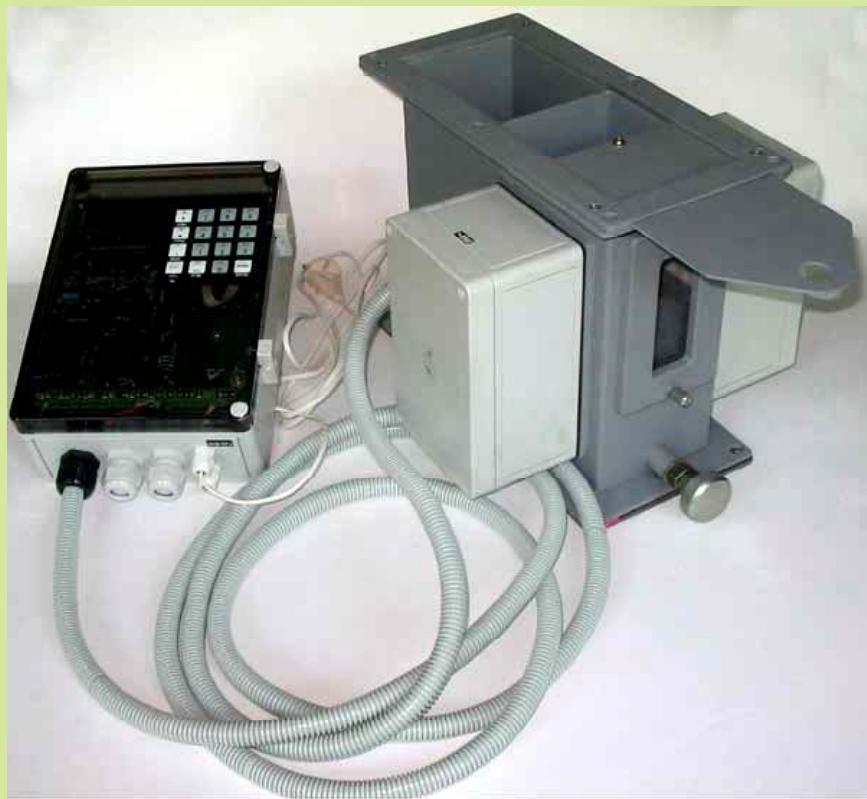
Принцип действия влагомера основан на измерении величины поглощения СВЧ энергии влажным материалом и преобразовании этой величины в цифровой код, соответствующий влажности материала. Влагомер обеспечивает автоматическую коррекцию результатов измерения при изменении температуры материала, имеет стандартный токовый выход (0-5; 0-20 или 4-20)мА, а также последовательный канал связи с ЭВМ RS-485.
